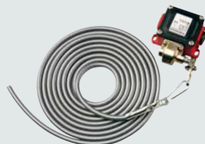
Tahový spínač s plastovým tahacím lankem montáž možná ve vodorovné nebo svislé poloze kryt z tlakového hliníkového odlitku IP 65. Délka lanka 4 m.
