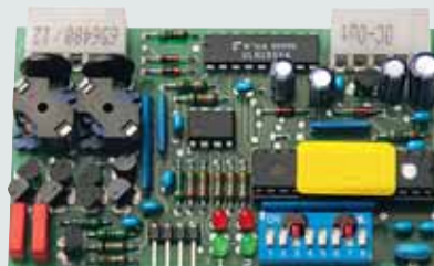
Vyhodnocovač indukčních smyček Nasazovací deska 1- nebo 2-kanálová. Vhodná pro dvě oddělené indukční smyčky. Dodávka bez kabelu smyčky.
