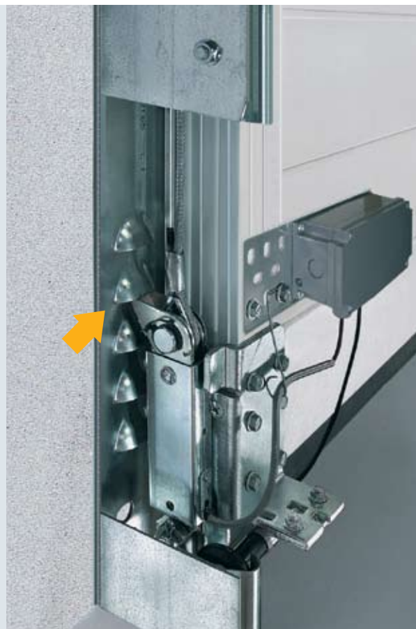
Zajišťovací hák zařízení proti zvednutí automaticky pevně zaskočí. Při otvírání vrat se hák opět uvolní.
